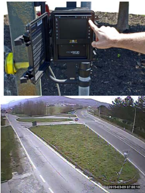
Figura 2.1.6. Caratteristiche del sistema di rilevamento MIOVISION
