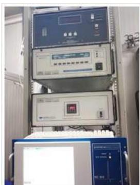
Le stazioni di rilevamento si compongono di una struttura base, della strumentazione di misura degli inquinanti atmosferici e delle apparecchiature per la visualizzazione, l'elaborazione e la trasmissione dei valori relativi ai parametri misurati. Il modulo di alloggiamento è costituito da una cabina in vetroresina. La disposizione interna della strumentazione è modulare, così da poter facilmente aumentare o diminuire il numero dei parametri determinabili.
