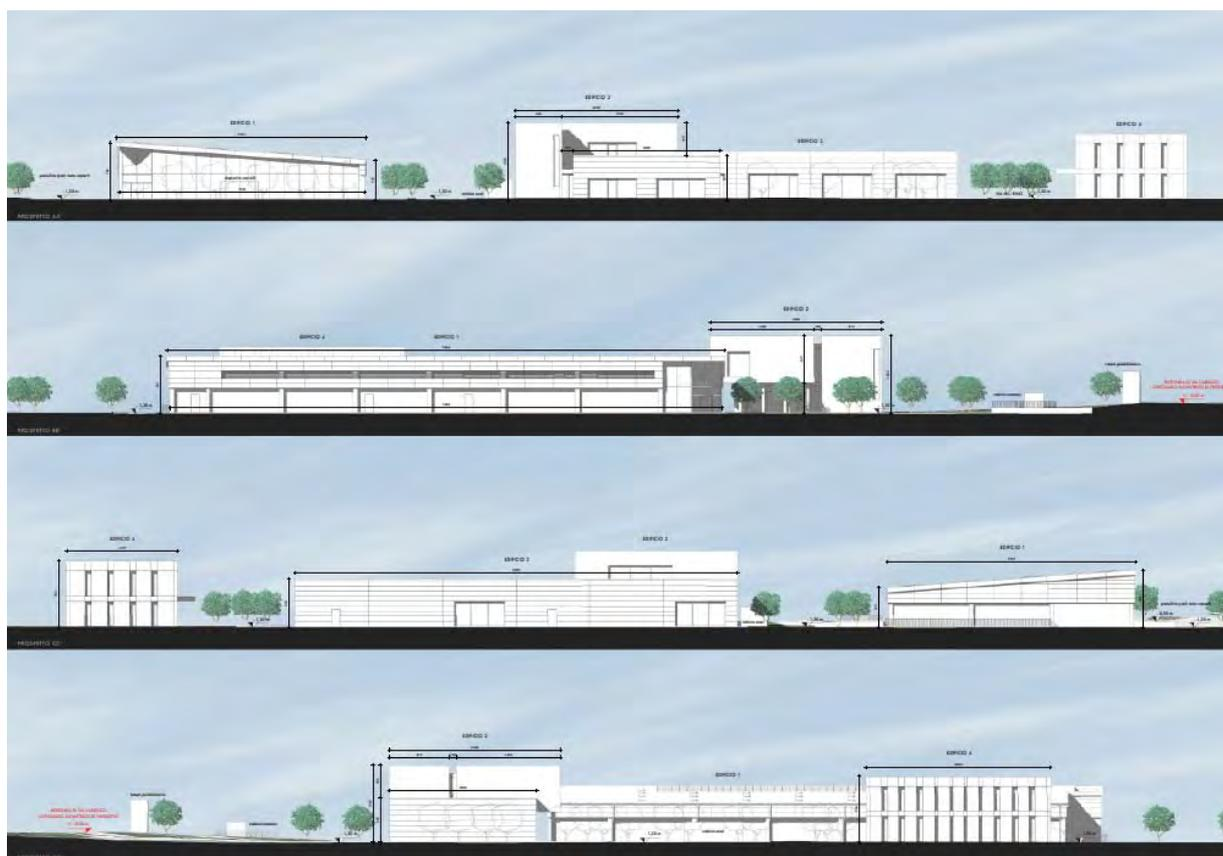
Il fabbricato dedicato alla media distribuzione per una superficie di vendita di 1.422 mq, per esigenze di massima libertà di lay-out, porta all'esterno le strutture verticali, che scandiscono la parte inferiore delle facciate tamponate con pannelli prefabbricati in c.a. tinteggiati di bianco e grigio, e vengono invece coperte nella porzione superiore da una fascia in pannelli orizzontali di Alucobond grigio silver; il fronte nord, rivolto verso via Carducci, è interamente vetrato.
