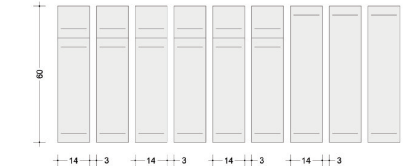
panchina modulare / tipologia 2 / pianta / scala 1:10
