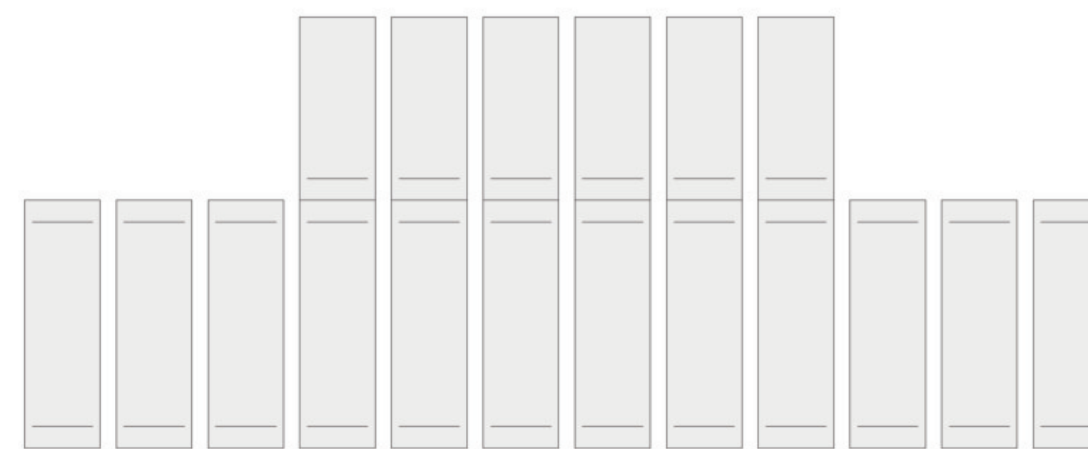
panchina modulare / tipologia 1 / vista frontale / scala 1:10
