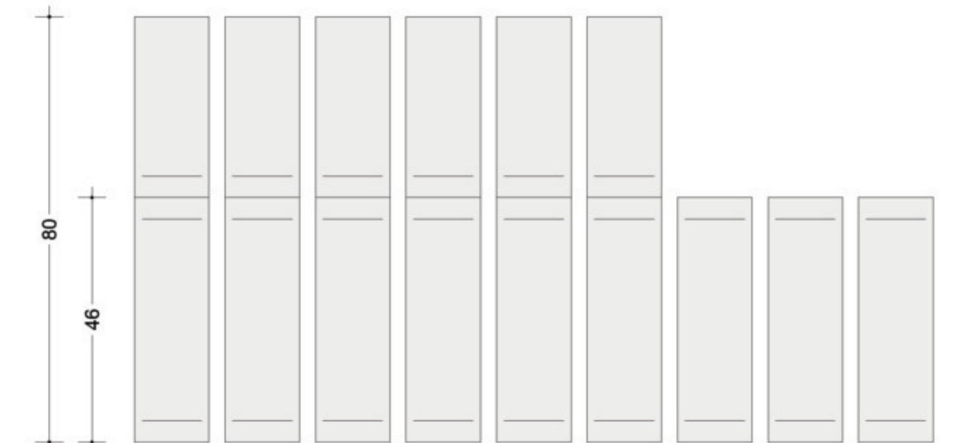
panchina modulare / tipologia 2 / vista frontale / scala 1:10
