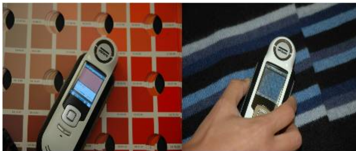
Rilevazione colorimetrica mediante utilizzo del dispositivo "Colorado" Sikkens
