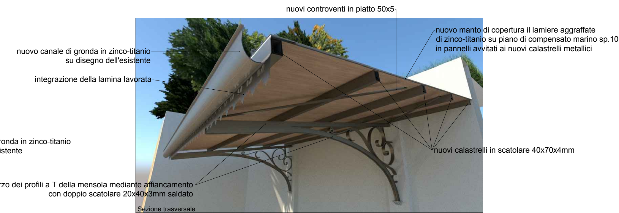
Sez 3D Soluzione di rinforzo e rifunionalizzazione della copertura - Sezioni 3D
