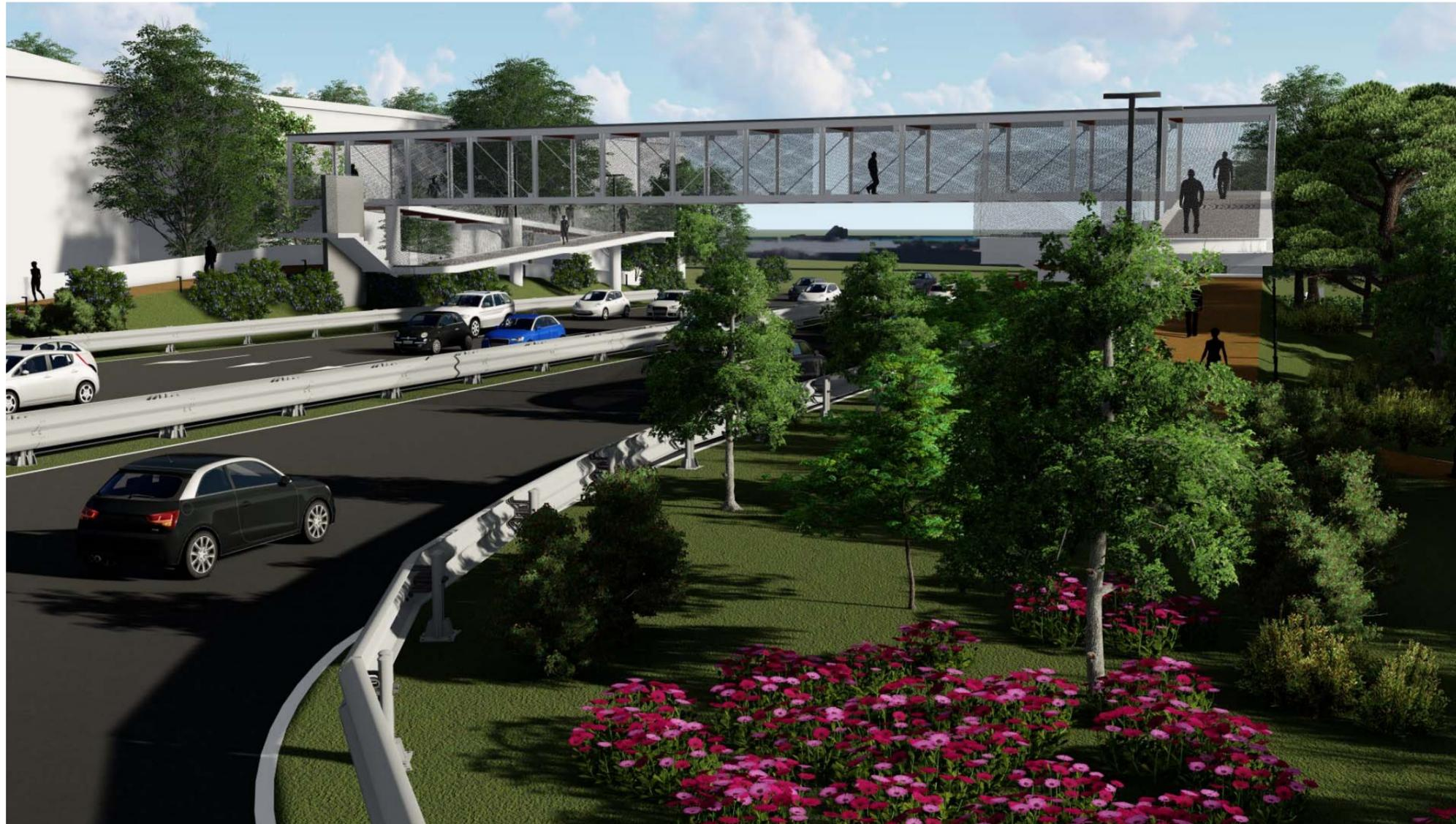
Appare quindi indispensabile una soluzione a livelli sfalsati - possibilmente non in sottopasso per via delle interferenze con i sottoservizi, rischio allagamenti, scarsa sicurezza - ma in sovrappasso.
