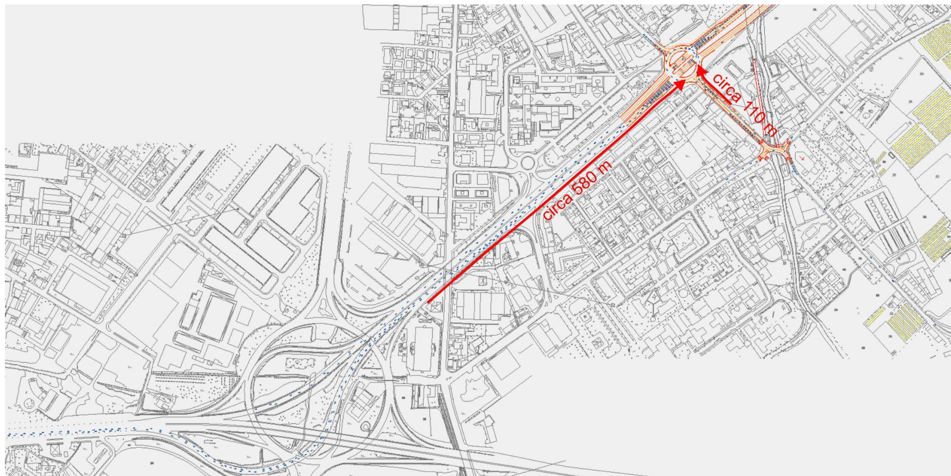
Figura 58 – SC_INT – Ipotesi 4: Nuova Rotatoria – Istantanea di simulazione – Accodamenti massimi Rami 1A e 1D
