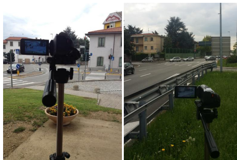
Foto 16 – Postazione di rilievo con telecamera
