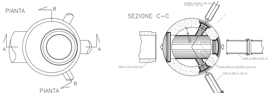
**POZZETTO PER TUBAZIONI DI DIAMETRO MAX mm 600 CON IMMISSIONI DA VARIE ANGOLAZIONI CON RIVESTIMENTO INTERNO IN POLYCRETE**
