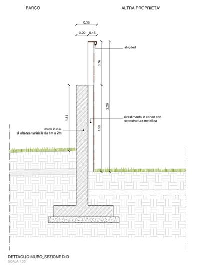
DETTAGLIO MURO, SEZIONE D-D
