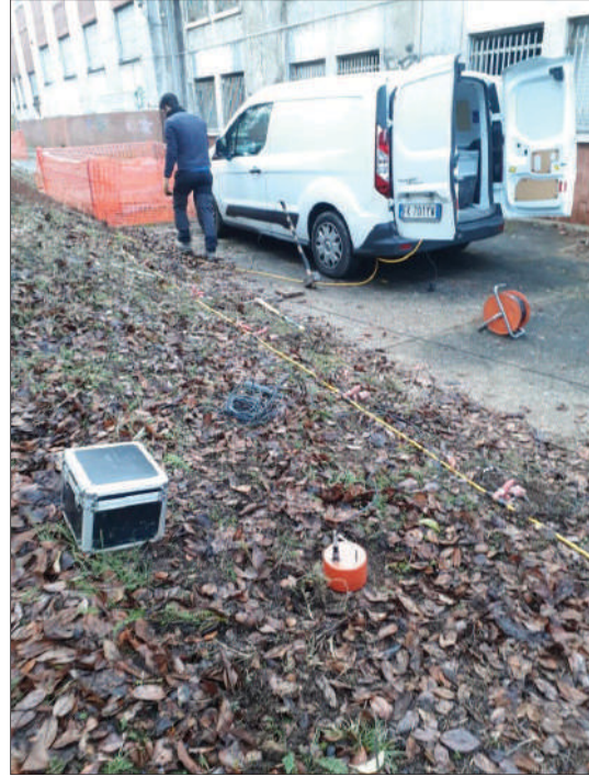
Misura del microtremore sismico mediante tecnica H.V.S.R.
